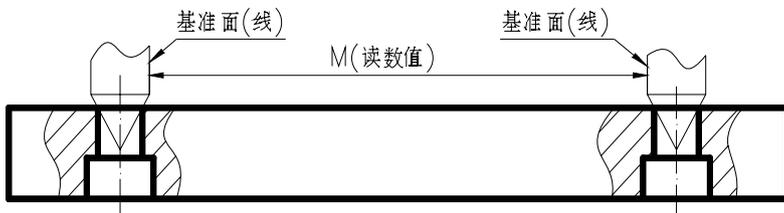
图 C.4 初始值设定为“零”值时的示值检查读数示意图（圆柱形测头）
