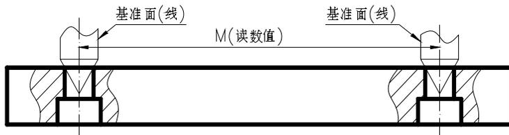
图 C.3 初始值设定为测量范围标定初始值时的示值检查读数示意图（圆锥形测头）
